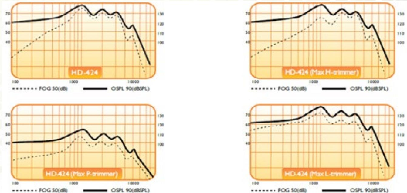
As medições das curvas representadas são em configuração padrão do dispositivo. Todos os trimmers e potenciômetros são colocados em posição máxima. Todos os dados técnicos estão sujeitos à alteração sem aviso prévio.
