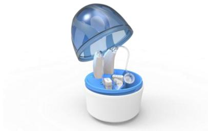
1. Coloque os aparelhos auditivos nas 2 entradas de carregamento superiores sem os módulos das baterias.
